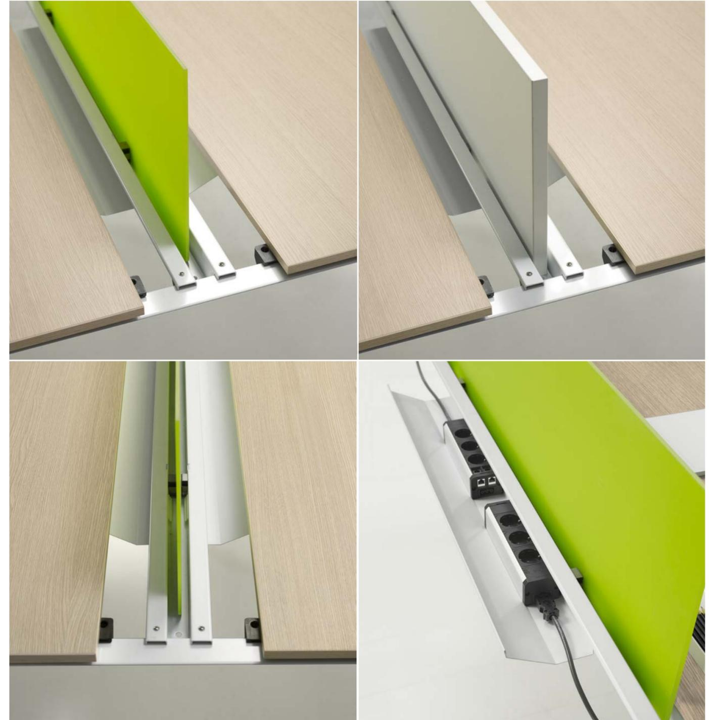
I tavoli multipli sono dotati di una trave centrale attrezzata, studiata per l'inserimento di pannelli di varie tipologie e dimensioni. Due morsetti nascosti all'interno della trave bloccano il pannello una volta inserito senza l'utilizzo di viti e altri sistemi di fissaggio.
